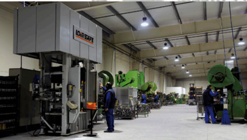
Hydraulic and eccentric presses Sección de prensas
