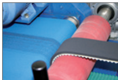
Mechanisch bearbeitete Riemenrücken
