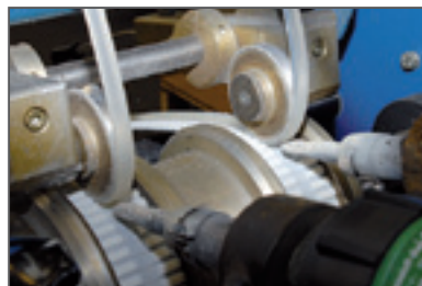
Zahnriemen mit Keilführungsleisten
