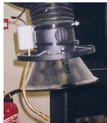
LIGHT SENSOR monté sur bras télescopique
