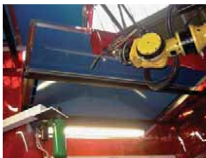
Hotte acier double peau 2000 x 1500 mm au-dessus d'une zone robot
