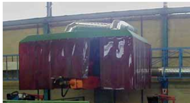
Hotte polyester 3 500 x 2 400 mm embarquée sur axe linéaire du robot L 12 m - Ventilateur 7 000 m 3 /h - Gaine \varnothing 400 mm.
