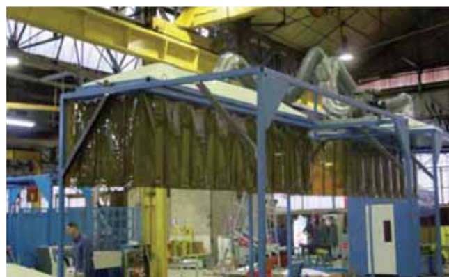
Hotte polyester fixe 4 000 x 1 500 mm sur axe zone robot
