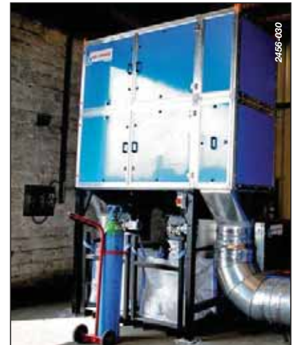
Gamme "VERSION SÉPARÉE", 6000 à 32000 m 3 /h, 6 à 32 cartouches filtrantes, version avec fûts à poussières ou écluse rotative et BIG-BAG.
