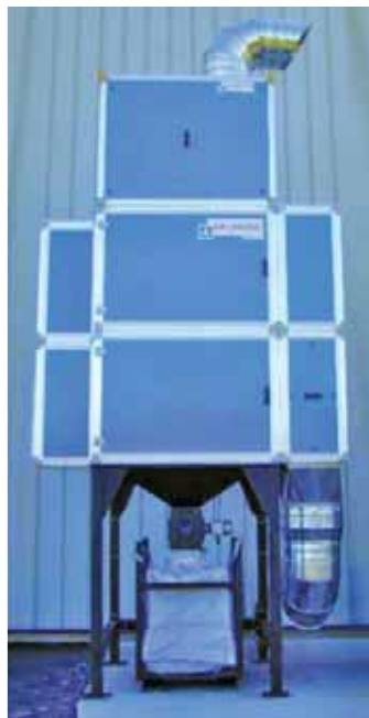
Gamme "TOWER", 6000, 8000 et 12000 m 3 /h, 6 à 12 cartouches filtrantes, version avec fûts à poussières ou écluse rotative et BIG-BAG.
