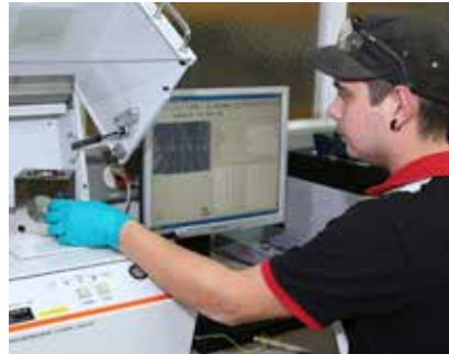
X-Ray zur Schichtdickenmessung und Materialanalyse
