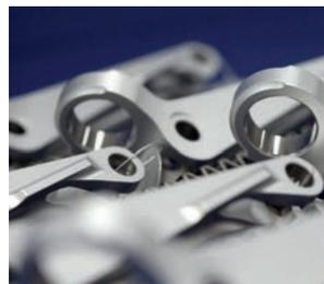
IVD-Aluminium-beschichtete Bauteile mit Maskierung im inneren Durchmesser. Nach der Beschichtung erfahren die Bauteile eine Chrom(III)-haltige Passivierung.
