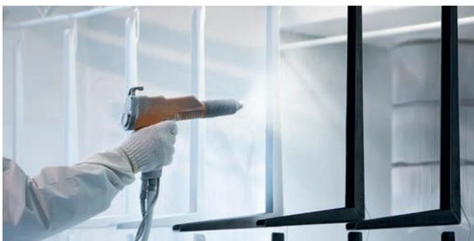
Pulverbeschichtung: Auftragen von Pulverlack in der Spritzkabine
