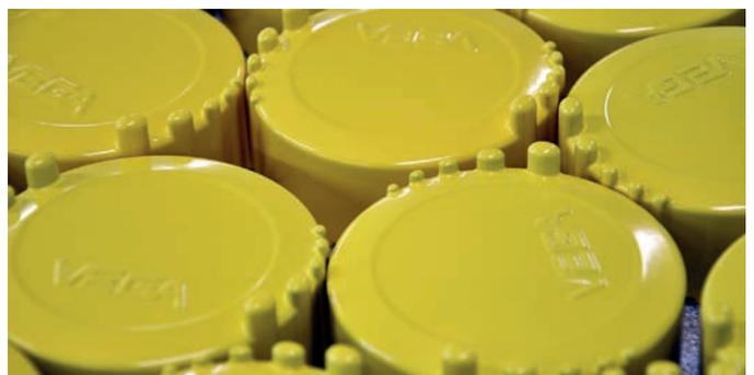
Deckel für die Gasverteilung mit Pulverbeschichtung
