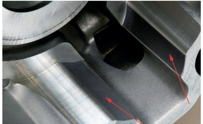
Aluminium-Bauteil mit Flächen, die im LASOX-COAT®-Verfahren beschichtet wurden
