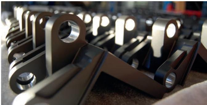
Verschlussklappen mit TempCoat® als Korrosionsschutz
