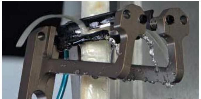
HART-COAT®-GL beschichteter (25 µm) Hebel und Messerträger für Spargelschälautomaten. Die Schicht schützt hier vor Korrosion und bietet verbesserte Reinigungs- und Verschleiß-eigenschaften.
