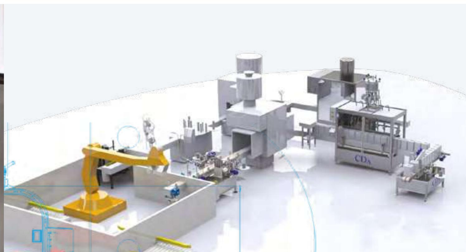
Étiqueteuse, remplisseuse et capsuleuse automatique pour les bouteilles de bière avec capsules 26 mm
