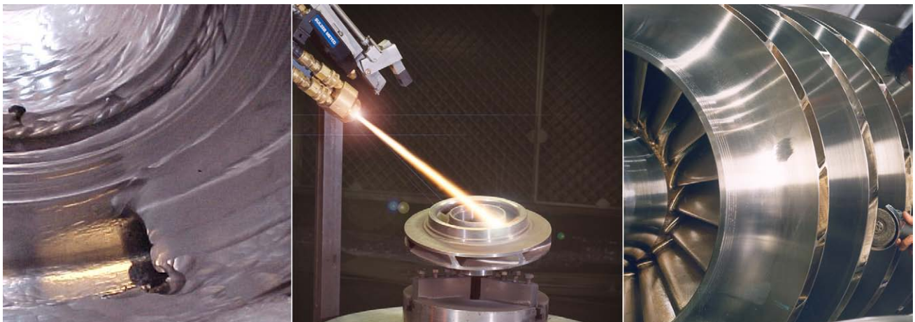
Bauteil unbehandelt Verschleiß durch Erosion
