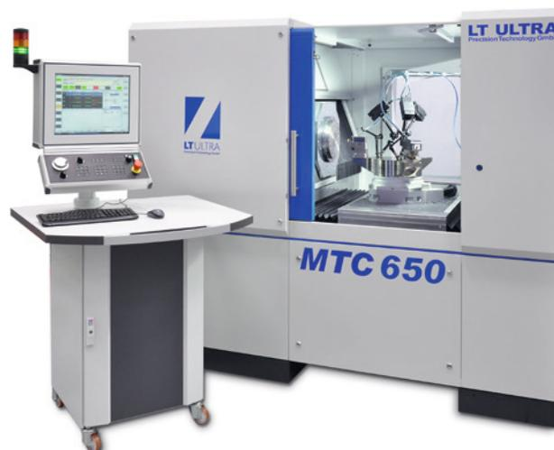
Die UP-Drehmaschine MTC 650 ist die größte Serienmaschine des Unternehmens
