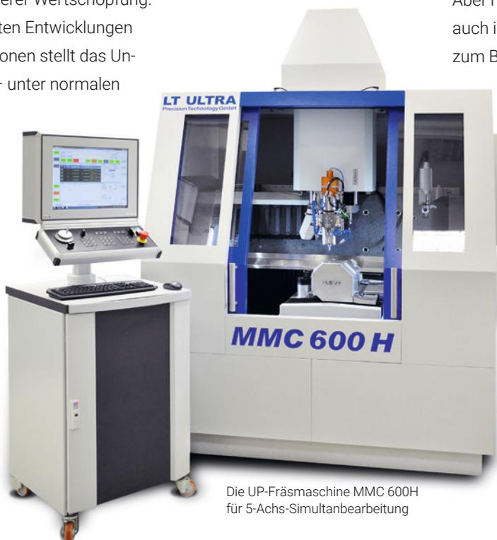
Die UP-Fräsmaschine MMC 600H für 5-Achs-Simultanbearbeitung
