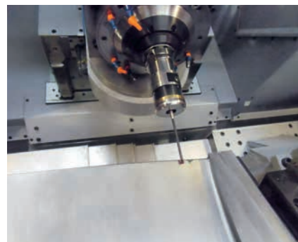
3D Vermessung einer Turbinenschaufel in der HSTM
