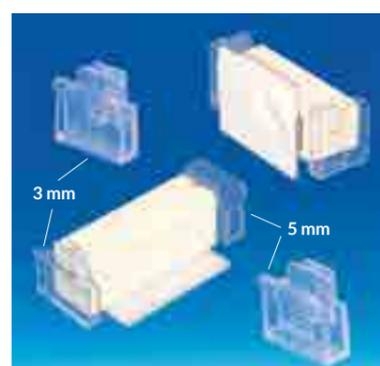
Bloc Promobase® avec adhésif permanent, permettant de présenter des panneaux de 3 ou 5 mm selon le sens d'utilisation. Positionnable sur toutes surfaces lisses et propres. Façade transparente pour ne pas cacher le visuel du panneau. Prévoir 2 plots pour un panneau de 1000 mm et 3 plots pour un de 1330 mm. Hauteur maxi. conseillée panneau droit : 300 mm.
