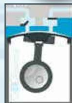
Pour pomper les gaz agressifs sans dommage, le choix des matériaux appropriés est décisif. KNF a doté ses pompes de têtes entièrement réalisées avec le PTFE, PDVF et FFPM.
