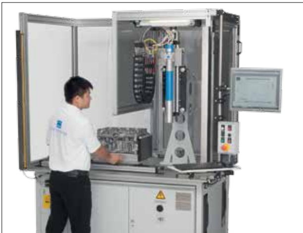
Prüfplatz mit manueller Beladung für Kleinserien-/Prototypenfertigung
