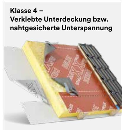
**Klasse 4 – Verklebte Unterdeckung bzw. nahtgesicherte Unterspannung**
