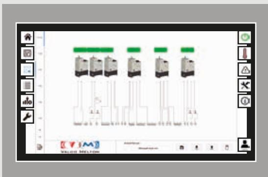
El Smart Control permite al operario visualizar el sistema de hot melt completo (platos seguidores, fusores, aplicadores y accesorios). Permite controlar de manera sencilla el proceso productivo, crear recetas, modificar parámetros y programar alarmas. El sistema también genera y muestra informes de uso de adhesivo y simplifica la monitorización de las tareas de mantenimiento mediante notificaciones programadas para los recambios (resistencias, módulos, bombas, filtros) y los mantenimientos.
