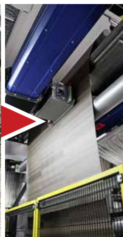
Operación de revestimiento y esparcimiento
