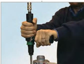
Per situazioni applicative gravose, con riferimento alla Norma ISO 11148-6, soprattutto in presenza di coppie superiori ai 4 Nm (utensili dritti) e superiori ai 10 Nm (utensili a pistola), un utile ausilio per evitare reazioni al sistema mano/braccio è l'impugnatura ausiliaria (in dotazione con alcuni modelli) che consente di ridurre la reazione del contraccolpo scaricandolo su due mani anziché una.
