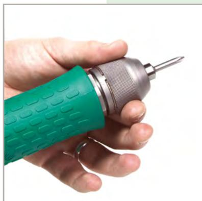
Nei modelli CSE...RE la regolazione della frizione a salterelli è esterna: si può aumentare o diminuire la coppia di serraggio **semplicemente ruotando la ghiera zigrinata dell'avvitatore** nel senso indicato dalle frecce.
