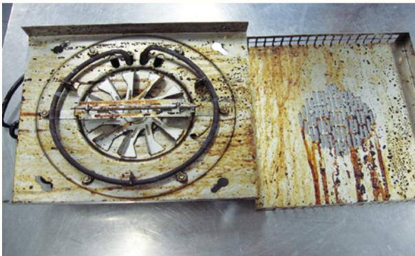
Starke Fettinkrustierungen an einer demontierten Heizspirale mit Lüftungsrade eines Konvektomaten.
