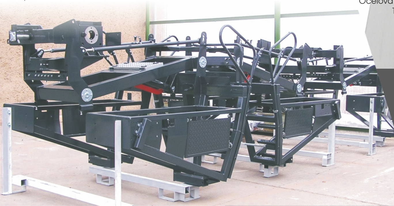
Smontované ocelové konstrukce pro zemědělskou mechanizaci
