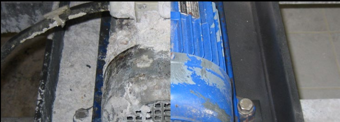
Werkstücke, die aus einem Materialmix aus Metall und Kunststoff bestehen, bleiben beim Trockeneisstrahlverfahren unbeschädigt. Da das Strahlmedium kein Wasser enthält, können sogar elektronische Bauteile gereinigt werden, ohne Gefahr zu laufen, einen Kurzschluss zu verursachen.
