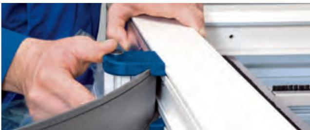
Exemple de mise en œuvre (CB) : Montage sur une fenêtre en PVC
