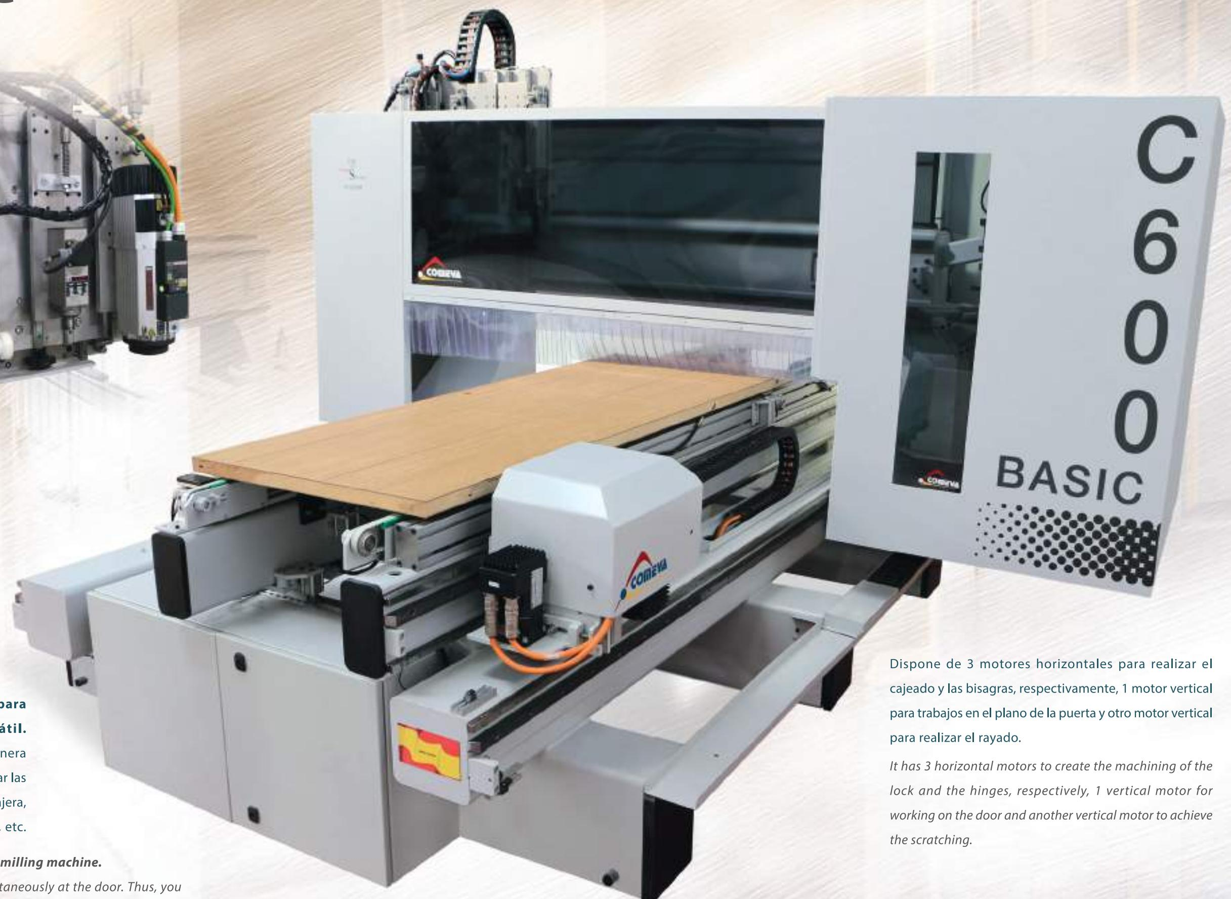
**El modelo C-600 BASIC es una máquina para mecanizar puertas muy rápida y versátil.**
