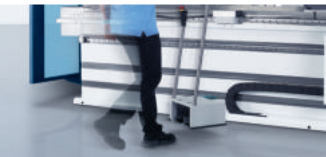
El interruptor de pedal inalámbrico termina con los tropiezos.
