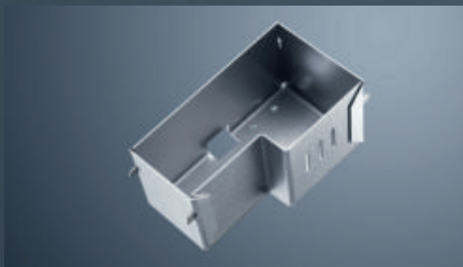
En función de la máquina, podrá realizar el plegado con alturas de caja de hasta 518 mm.
