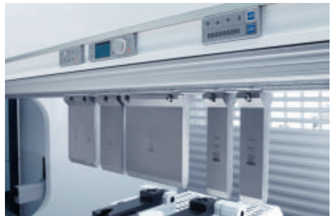
El Tool Indicator le muestra durante el equipamiento el lugar preciso de colocación de los útiles de plegado.
