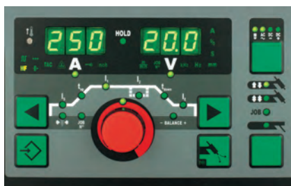
/ Panneau de commande MW 2500 Job
