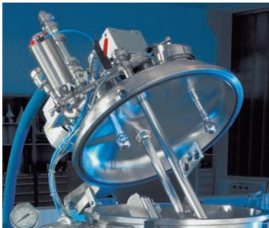
Nahezu alle Lechler Präzisionsdüsen für die Behälter- und Anlagenreinigung sind CIP-fähig und können während des Produktionsprozesses in den Anlagen verbleiben.
