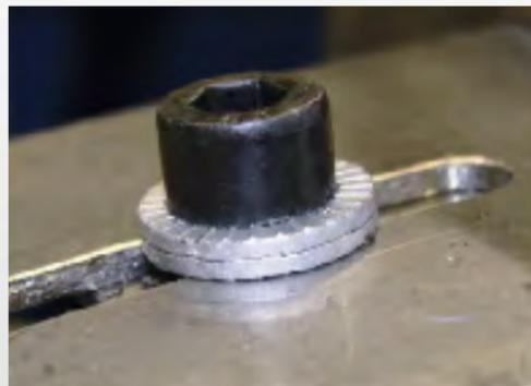
El sistema de seguridad más competitivo y de calidad para la fijación de tornillos con aplicaciones críticas. Cuando el tornillo y/o tuerca se aprieta, los dientes radiales exteriores de las arandelas HEICO-LOCK se fijan sobre la superficie de contacto. En caso de esfuerzo o tensión, el efecto de cuña de las levas entre las dos partes de la arandela, bloquea cualquier rotación del tornillo/tuerca, evitando que estos se aflojen.
