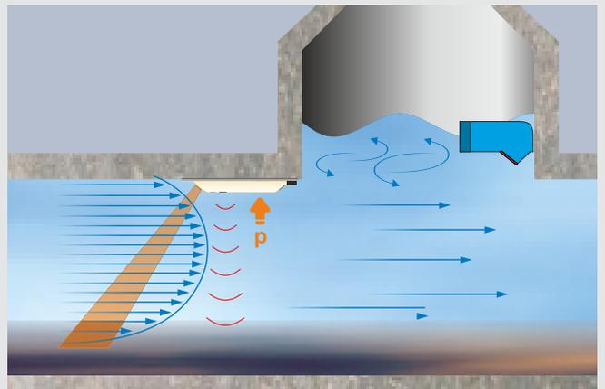
**Mise en charge:** acquisition du profil d'écoulement via mesure de débit par ultrason combinée à une mesure de niveau hydrostatique. Une mesure de niveau ultrason supplémentaire enregistre les dépôts accumulés sur le fond.
