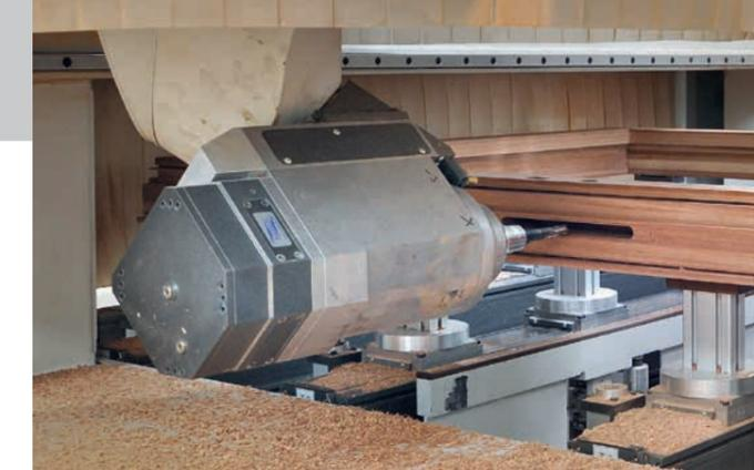
Der vollautomatische Trägertisch ist überaus umfangreich für alle denkbaren Komplettbearbeitungen bestückt. Auch Pfostenspanner sind an Bord.
