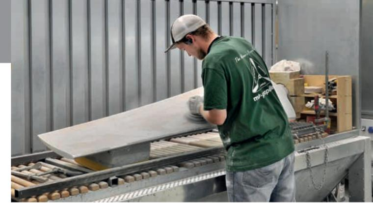
*Schleifen des Propellerblattes nach Auftragen/Trocknen des Füllers. Hier ist Handarbeit unerlässlich.*
