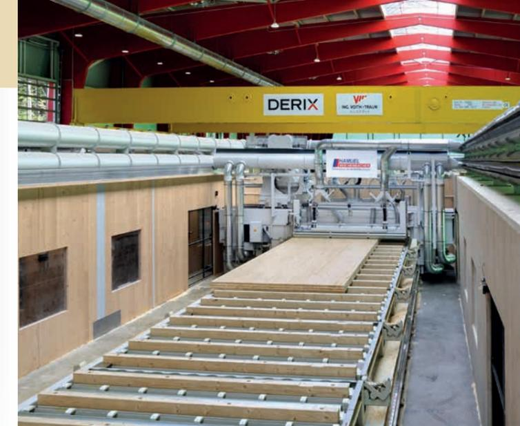
Bei Derix in Westerkappeln sind ausgesprochen kompakte und leistungsstarke 5-Achs CNC-Bearbeitungszentren installiert.
