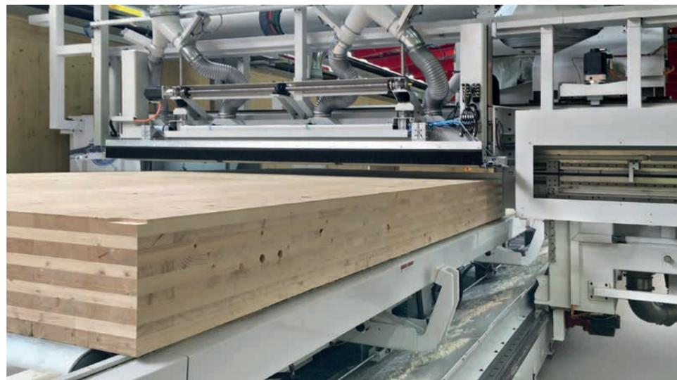
Für den Bauteiltransport innerhalb der Maschine sind eine Rollenbahn und eine Querfördereinrichtung installiert.
