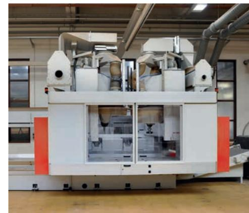
Das Doppelportal ist mit einem 5- sowie einem 4-Achs-Aggregat bestückt und hochflexibel für Einzelfertigung ausgelegt. Das Bearbeitungszentrum kann Teile bis zu einer Größe von 6.140 x 2.170 mm bearbeiten.
