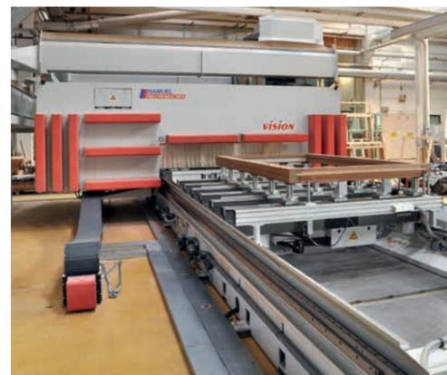
Kratzband- und Querförderer sowie die kraftvolle Absaugung halten die Maschine sauber.
