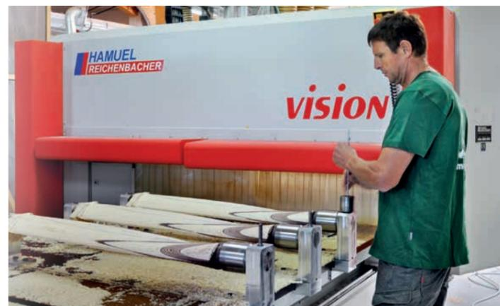
*Alois Kermer an einem CNC-Bearbeitungszentrum vom Typ VISION Inline. Die Propellerblätter werden für das Fräsen der Blattunterseite in speziellen Aufnahmen gedreht.*
