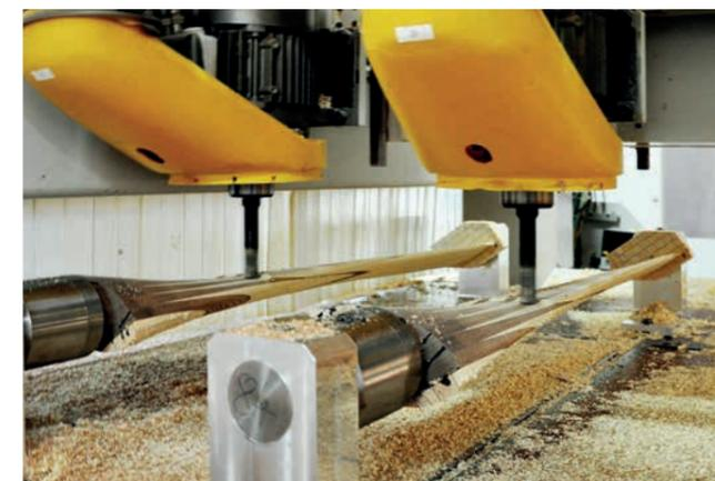
*Nach der Grobfräsung folgen die Feinfräsungen, die je Seite bei einem kleinen Propellerblatt rund 25 Minuten dauern.*
