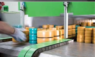
Im Langlaufofen werden die entformten Räder bis zu 20 Stunden getempert
