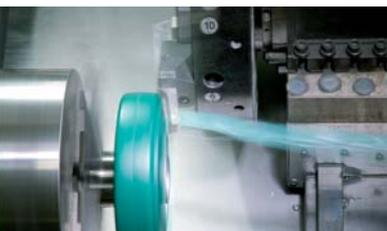
Abdrehen des Übergusses mit computergesteuerten CNC-Drehmaschinen
