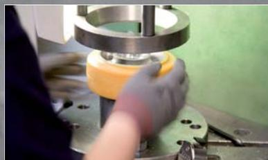
Jedes einzelne Rad wird auf Belagsablösung geprüft
