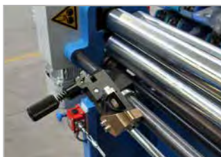
Butée latérale spéciale pour un cintrage conique (option).
