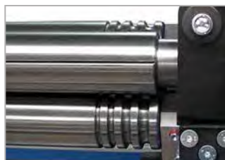
Rainures de pliage et rainures pour insérer le fil de fer (option).
