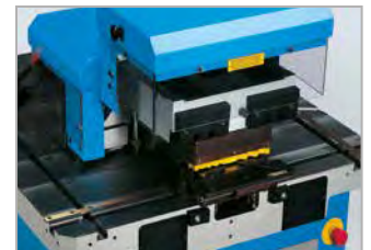
Unité de cintrage de rayon. Pour rayons de 3 à 15 mm dans épaisseur de tôle jusqu'à 6 mm
