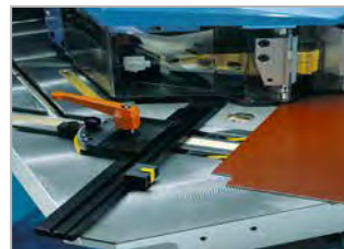
Système de positionnement de précision. Butées réglables par pas de 15° et butées pivotantes pour les doubles rainures en T du plateau
