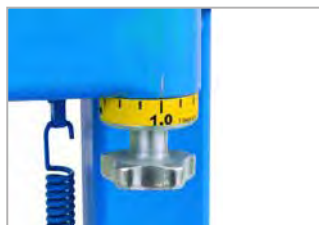
Réglage du tablier pour obtenir un rayon optimal avec différentes épaisseurs de tôle
