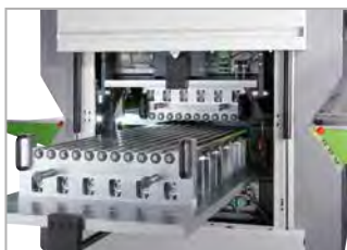
Exemple d'un dispositif de nettoyage et de remplacement rapide à moteur électrique.
