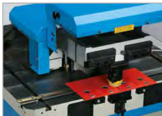
Support d'outils de poinçonnage. Poinçonner avec un système d'outils Trumpf jusqu'à D=50 mm (rond, carré, gabarits)
