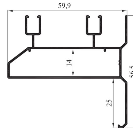
ATM 2000 DORMANT SIMPLE AVEC COUVRE JOINT
