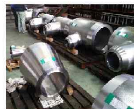
TEE, REDUCER カーボン (A105M) 合金 (SA182M F11CL2)
