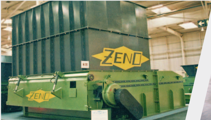
ZENO-Zerkleinerungsmaschine mit 5 m Arbeitsbreite und 60 m 3 Trichtervolumen
