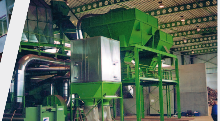
ZENO-Bauschuttsortierung mit automatischer Schwergutreinigung durch Windsichtung
