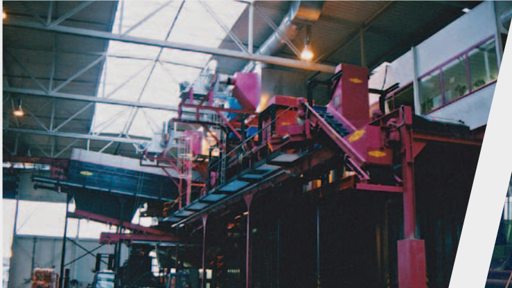
DSD-Sortieranlage mit modernster Technik Leistung: 8 t/h
