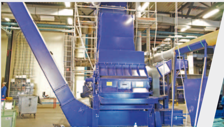
Nachzerkleinerungsanlage mit ZENO-Schneidmühle
