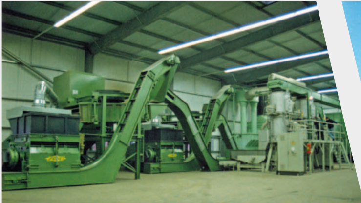
Agglomerataufbereitungslinien mit Schwingsieben und Nachzerkleinerung
