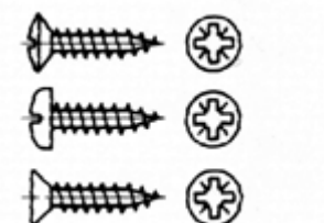
Spanplattenschrauben/ABC-SPAX-"S"-Schrauben mit Pozidriv-Kreuzschlitz (Artikel 88019-88099) Linsensenkkopf Halbrundkopf Senkkopf Chipboard screws with pozidriv raised countersunk head/pan head/countersunk head
