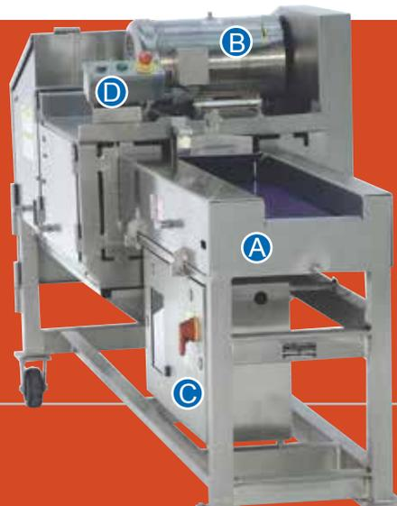
Aufklappbare Bandabdeckungen erleichtern die Wartung und den Wechsel der Zufuhrbänder. Die Zufuhrbandspannung lässt sich leicht durch das Drehen einer Mutter [ A ] an der Außenseite der Maschine einstellen. Das Urschel Modell M6 bietet einen Edelstahl-Motor [ B ], einen unter dem Maschinenrahmen integrierten Schaltschrank [ C ] sowie leicht zugängliche Stopp-/Start-Bedientaster [ D ].
