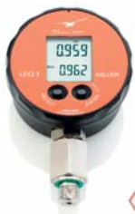
LEO 1 (mit "Peak"-Funktion) 5000 Messungen/Sekunde -1...1000 bar
