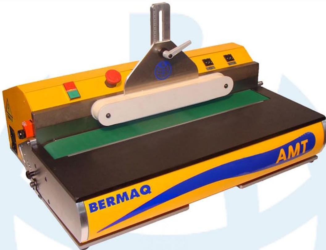
Máquina de sobremesa para el pulido de piezas de acrílico y metacrilato (PMMA) con un acabado de gran calidad. En la máquina AMT, podemos posicionar la mesa para conseguir biselos o ángulos de hasta 60° de inclinación. Ideal para el pulido de piezas pequeñas.
