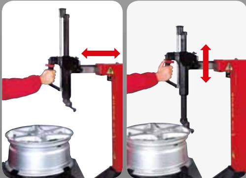
**2** **Blocage pneumatique simultané** du bras horizontal et de celui vertical porte-tourelle avec positionnement automatique de cette dernière dans la position idéale de travail.
