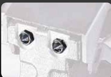
**7** **Appuis coulissants** avec zones de blocage interchangeable. Griffes en fusion plus hautes pour un meilleur blocage de la jante par l'intérieur et par l'extérieur. **7** *Verschiebbare Radauflagen mit auswechselbaren Spitzen. Höhere Spannklaue aus Speziallegierung zum stabileren Spannen der Felge von innen und von außen.*
