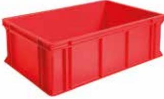
LogiLine-Behälter in Euro-Standard-Massen sind abgestimmt auf die Palettennorm 1200 x 800 / 1200 x 1000 und beliebig, auch gemischt, stapelbar. Optimales Nutzvolumen, lediglich 2 mm Konizität. Hergestellt aus Polypropylen Copolymer PPC, erfüllen sie die einschl. gesetzl. Lebensmittelverordnungen. Sie sind äusserst chemikalien- und säurefest, temperaturbeständig bis 130°C (waschbar), hygienisch und langlebig. Sehr hohe max. Stapelbelastung bis 800 kg.
