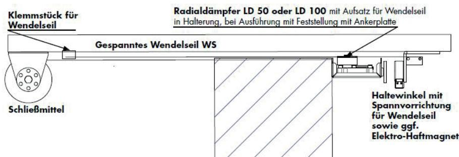
Die Zeichnung zeigt die Komponenten des DICTAMAT 50 WS. Sie können beliebig kombiniert werden. Bei der Freilaufausführung wird die Halterung mit dem Radialdämpfer nicht am Türflügel befestigt. Sie läuft als Freilaufmitnehmer-Wagen direkt im Wendeseil und wird durch ein zusätzliches Stützseil stabilisiert.
