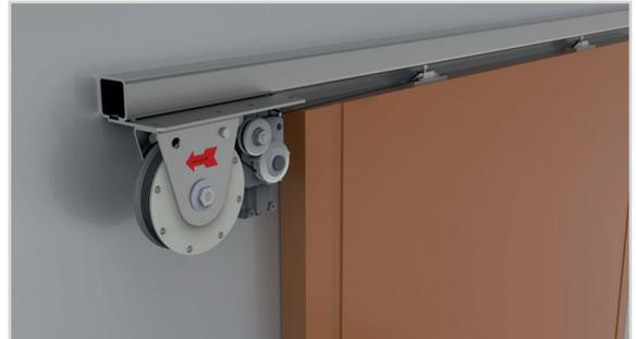
Das Zugseil der Federseilrolle wird bei den Kompakteinheiten direkt über die Seilrolle des Dämpfers zur Tür geführt, d.h. die Kontrolle der Schließgeschwindigkeit erfolgt direkt am Zugseil der Federseilrolle. Bei den Kompakteinheiten kann es bei manuellem Eingreifen in den Schließvorgang (Tür wird zusätzlich von Hand zugeschoben) daher zu einem sogenannten Schlaffseil kommen!
