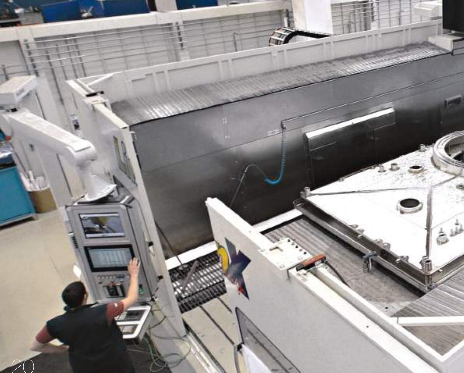
Gai si è attrezzata per progettare e costruire macchine ad alta velocità, in cui qualità di imballaggio e sincronismo siano ottimali. Macchine utensili dedicate di ultima generazione realizzano parti di dimensioni eccezionali in un unico pezzo, con indubbi vantaggi sul trasporto, l'installazione e la sanificazione del monoblocco.
