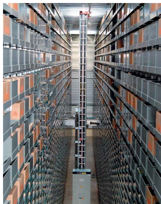
Plně automatizovaný sklad výrobků
