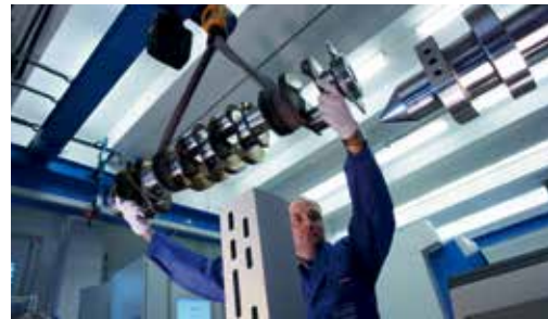
Einsatz in der Fertigung: Beladen einer Kurbelwelle bei der Werker selbstkontrolle
