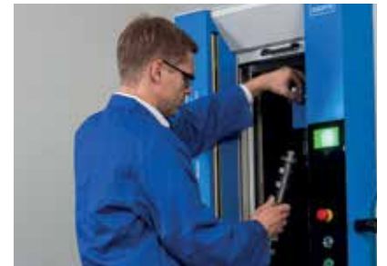
Einfache Bedienung der Messmaschine dank Reitstockschnellverstellung
