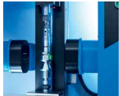
Einfaches Spannen des Werkstücks zwischen Spitzen
