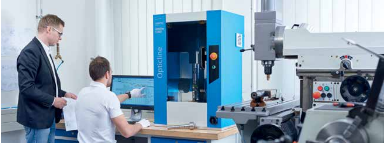
Opticline CS305 für die wirtschaftliche Messung von Drehteilen
