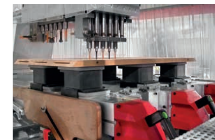
Bearbeitung eines Korpusteils mit einem 15-fach Bohraggregat.
