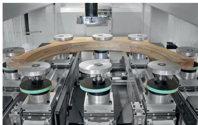
Automatischer Rüsttisch mit einzeln ansteuerbaren Klemmspannern für die Fenster-Rundbogenbearbeitung.
