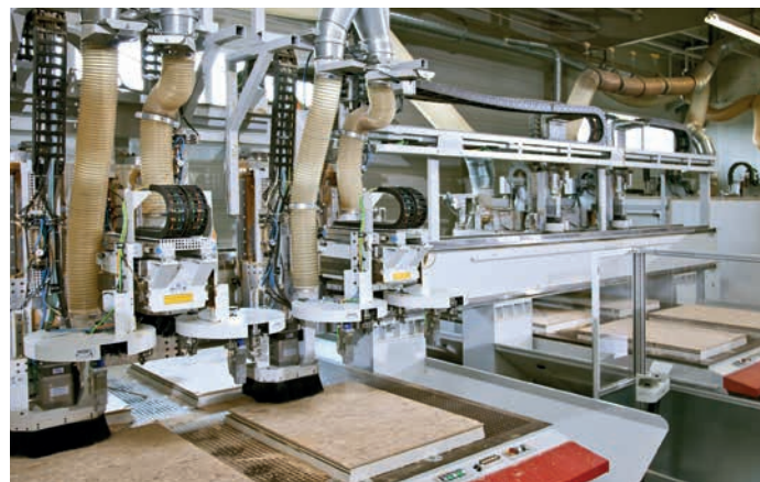
ECO mit 2 Tischen und 4 Aggregaten inkl. mitfahrenden 12-fach Werkzeugwechslern für Nestingbearbeitung.
