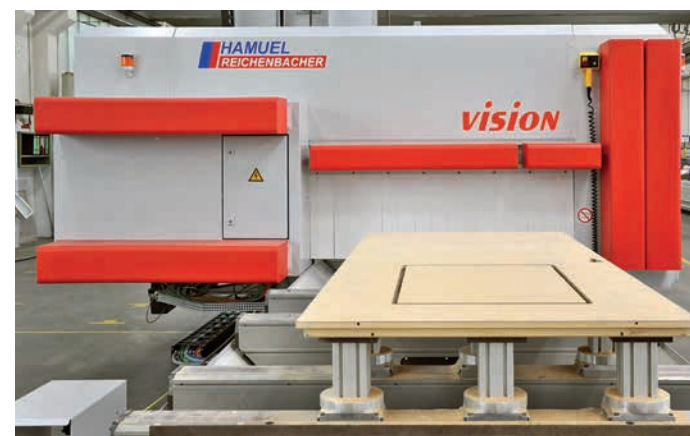
Türenbearbeitung mit Lichtausschnitt auf einer VISION mit automatischem Rüsttisch.
