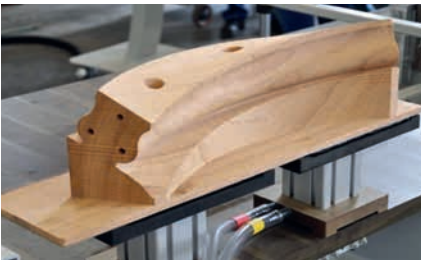
Interpolierende 5-Achs-Bearbeitung. Handlauf wird komplett bearbeitet und abgetrennt. Konstruktions- und Programm- erstellung über Softwarehersteller.
