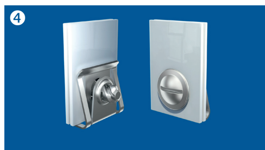
Inserción del tornillo en el receptor. La fijación queda colocada con medio giro y se suelta volviendo a girar.
