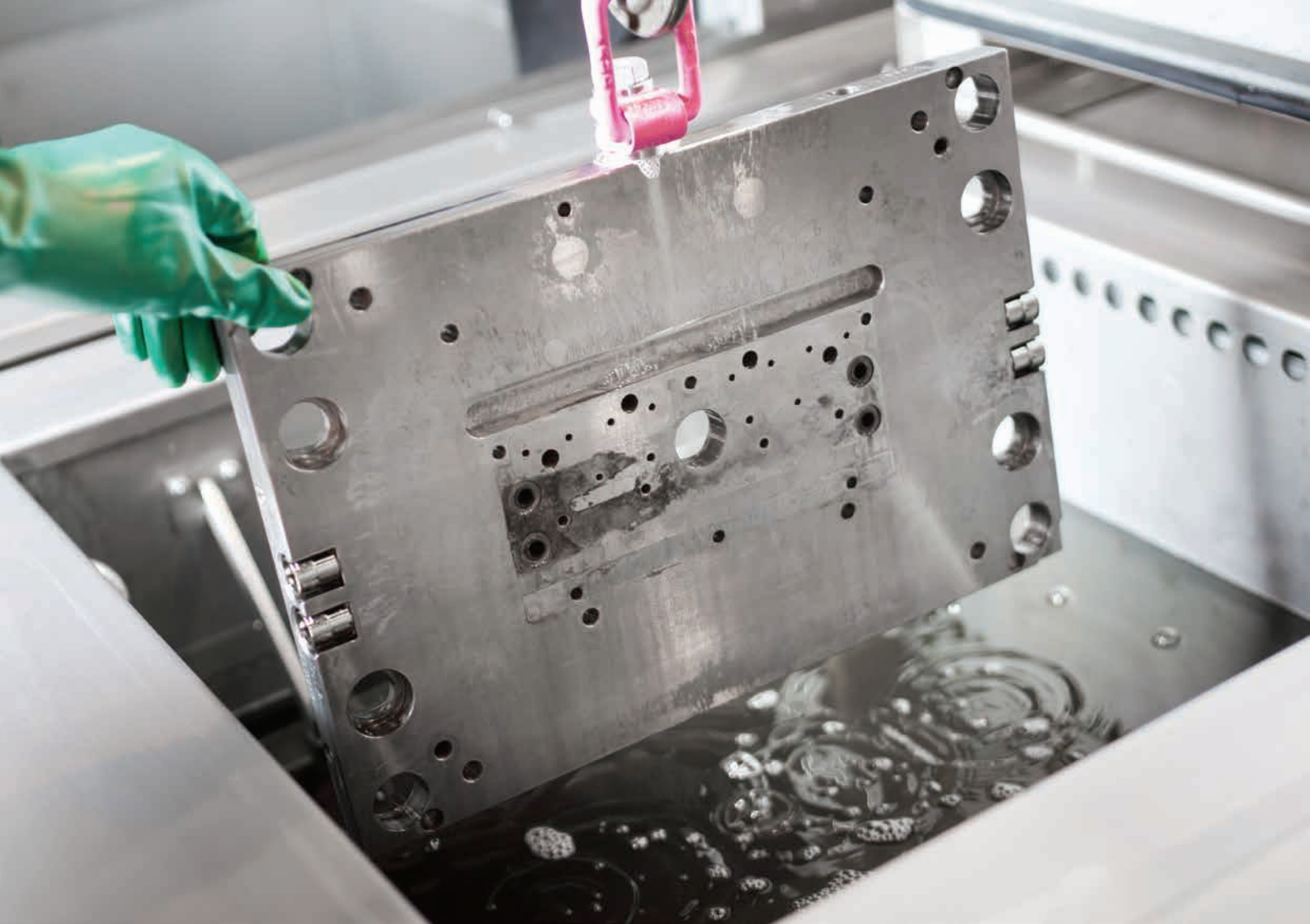
Wässrige Formenreinigung im Ultraschallverfahren
