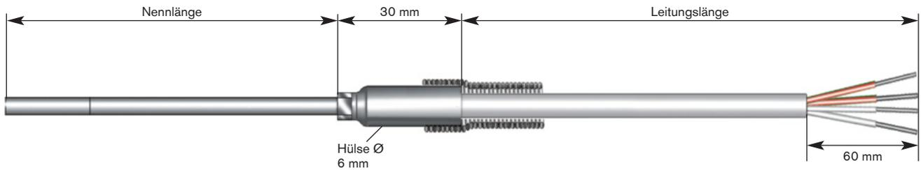
■ Dieser Temperaturfühler ist durch seine Bauform und hohe Temperaturbeständigkeit vielseitig einsetzbar. Durch seine schlanke Bauform und dem flexiblen Mantelmaterial kann der Fühler auch in schwer zugänglichen Positionen verbaut werden. In Verbindung mit einer entsprechenden Klemmverschraubung ist eine einfache Installation gewährleistet.
