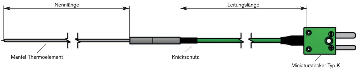
■ Dieser Temperaturfühler ist durch seine Bauform und hohe Temperaturbeständigkeit vielseitig einsetzbar. Durch seine schlanke Bauform und dem flexiblen Mantelmaterial kann der Fühler auch in schwer zugänglichen Positionen verbaut werden. In Verbindung mit einer entsprechenden Klemmverschraubung ist eine einfache Installation gewährleistet.
