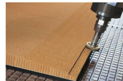
Wabenkernbearbeitung, zum Beispiel zur Versteifung von Flugzeugflügeln.
