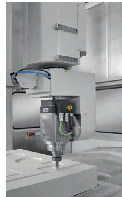
Bearbeitung von PU-Schaum mit der ECO-2616 A, 5-Achs-Gabel-Arbeitskopf, Z-Hub 1.300 mm.
