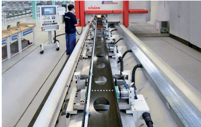
Bearbeitungszentrum mit eingespanntem H-Profilträger für den Flugzeugbodenbau.
