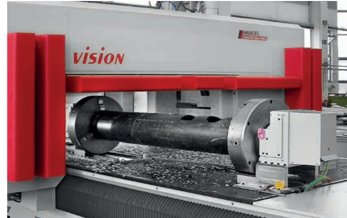
Rohrleitungsbearbeitung auf zusätzlicher NC-Drehachse (bis \varnothing 600 mm).
