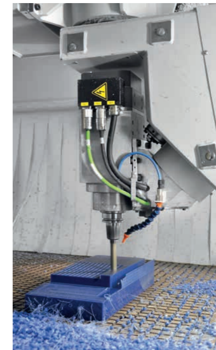
Zerspanung eines Kunststofferteils (Keil) für die Getränkeabfüllung mit der VISION-I-H, kardanischer 5-Achs-Arbeitskopf, Z-Hub 780 mm.
