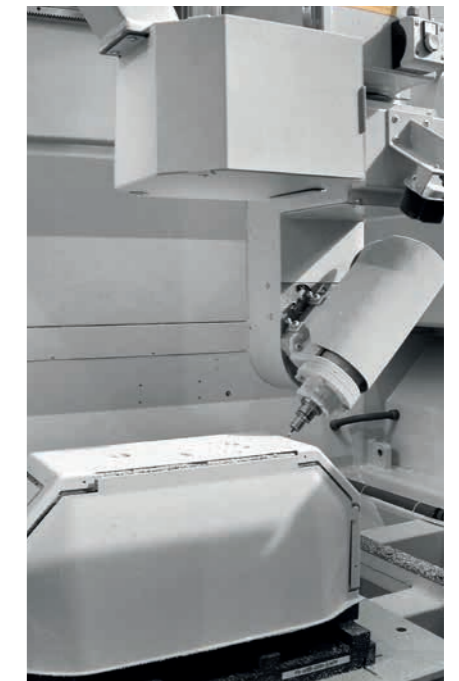
Fräsen eines Kunststofferteils mit der ECO-NT, 5-Achs-Gabel-Arbeitskopf, Z-Hub 1.000 mm.
