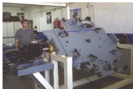
Svetsbord / 100% överlastningsbar, exakt positionering utan glapp
