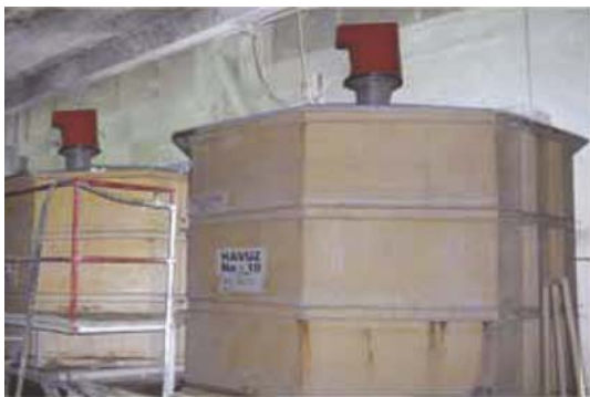
Sirapsomrörare / Låg energiförbrukning
