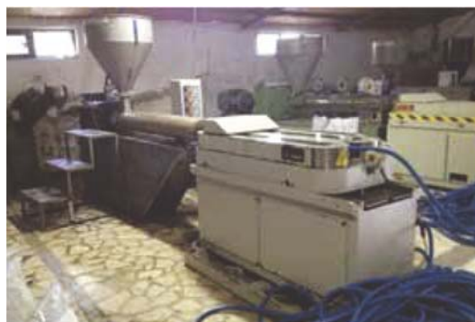
Extrudering av slang / Värmetålig
