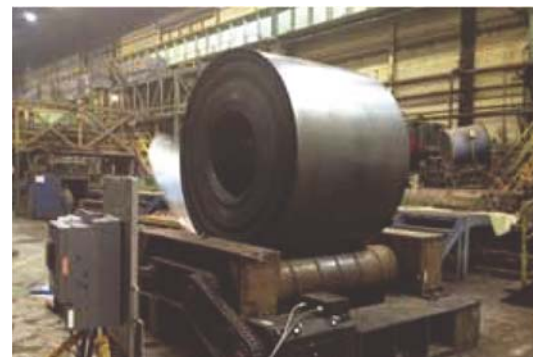
Avrullning / Energisnål, 100% överlastningsbar
