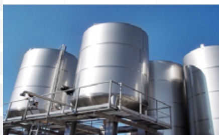
Zbiorniki procesowe z płaszczem grzewczym lub chłodzącym o dennicach stożkowych lub głębokotłoczonych
