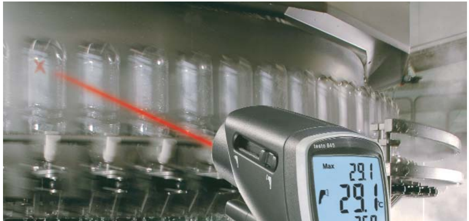
Mätning på PET-flaskor med IR-instrument för att undvika kontakt med rörliga delar av säkerhetsskäl
