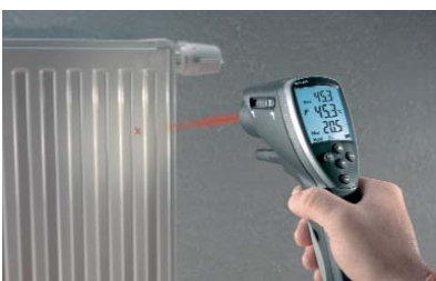
Mätning på radiator (målad) för snabb kontroll av t.ex jämnheten i ett injusterat värmesystem
